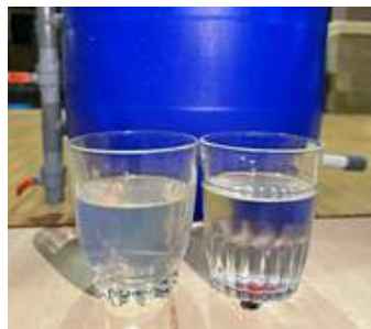
Gambar 4. Kondisi air sebelum dan sesudah melewati proses filtrasi.
