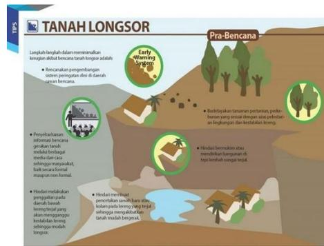
**Gambar 1.** Langkah-langkah dalam meminimalkan kerugian akibat bencana tanah longsor
